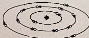
ALUMINIUM ATOOM, kern met 13 elektronen (op 3 schillen)
